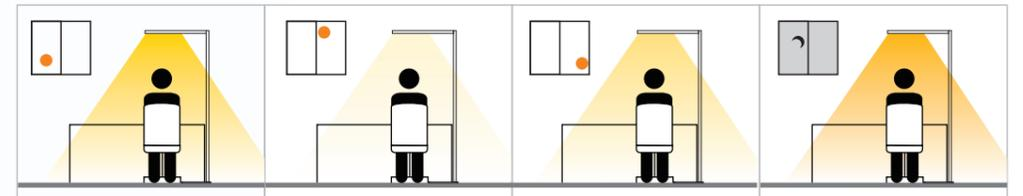
Nach jedem manuellen Einstellen der Helligkeit zeichnet das Steuergerät die vom Sensor erkannte Helligkeit auf und speichert diese bis zum nächsten Dimmen der Helligkeit. (Hinweis: Bitte achten Sie darauf, dass Sie die Lampe auf eine angenehme Lichtstärke einstellen und dimmen) Die Steuereinheit kann die Lichtleistung automatisch entsprechend den Änderungen der Umgebungshelligkeit herunter- oder hochdimmen, um ein relativ konstantes Lichtniveau für einen Schreibtisch in einem Büro zu haben.
