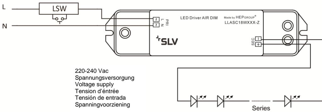
Die maximale Länge der Ausgangsleitung von 2 m darf nicht überschritten werden.
